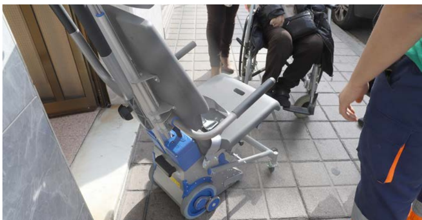
La cadira elèctrica (en primer pla) permet pujar la persona usuària per les escales
