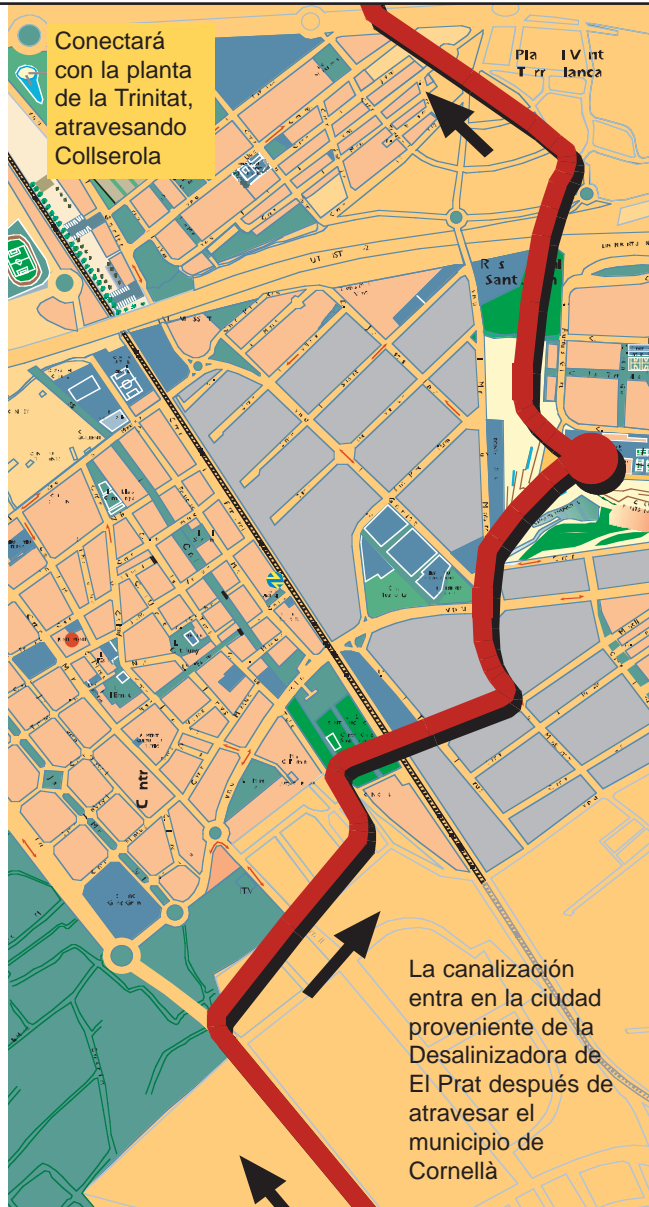
El recorrido de la canalización. Desde la nueva desalinizadora ubicada en El Prat, la canalización atraviesa el vecino municipio de Cornellà hasta llegar a Sant Joan Despí, discutiendo mayoritariamente por la zona industrial
