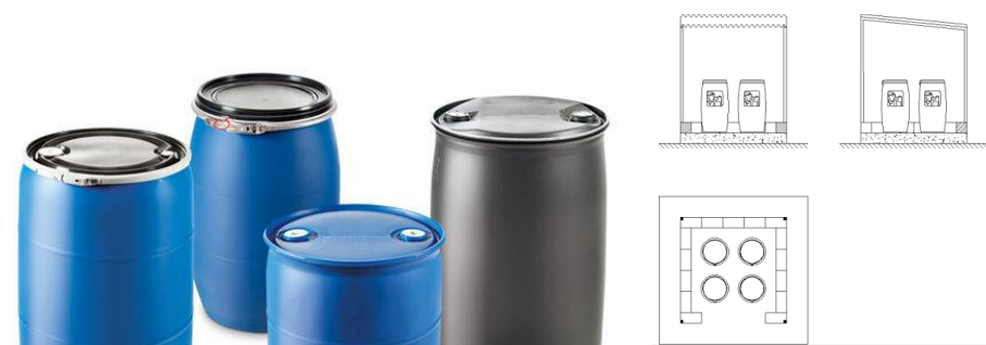
Figura 6. Contenidor de 220 l, amb tapa, per a la recollida de residus especials (4 unitats). A la imatge dreta es pot observar un croquis de la zona de recollida d'aquest tipus de residus: àrea amb solera impermeabilitzada, contenidors situats dins una cubeta de retenció i sota un cobert.
