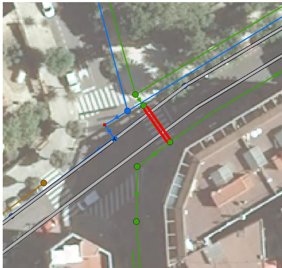
Figura 5. Ubicació dels 2 tubs de PEAD DN315 on es realitza la comprovació del funcionament hidràulic.
