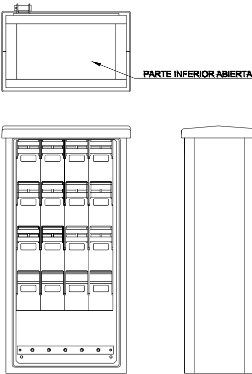
DETALLE ARMARIO DE DISTRIBUCIÓN BASE BUC
