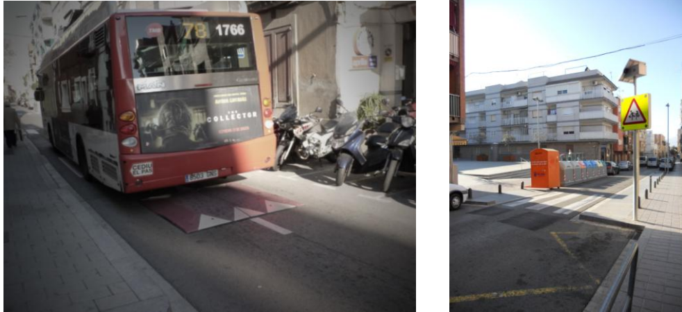
Fig. 39. Coixí berlinès al carrer Major i bandes reguladores de velocitat al c. Josep Maria Trias de Bes.
