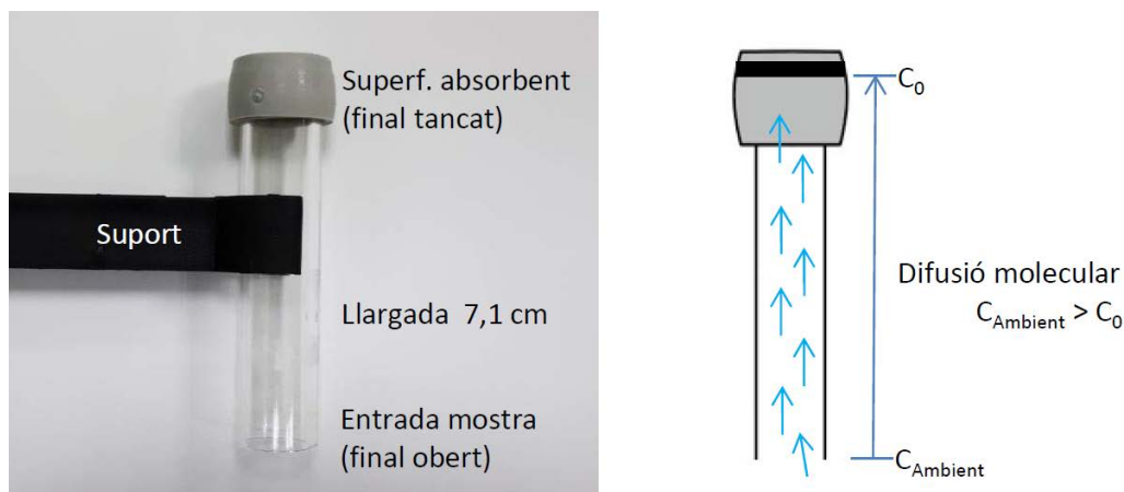
Figura 1: Principi de funcionament dels tub passius de difusió de NO 2 de tipus Palmes, on C_{\text{Ambient}} és la concentració de la mostra ambient i C_0 és la concentració a la superfície de l'absorbent.
